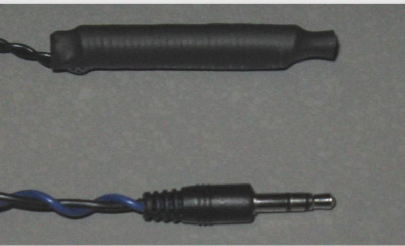
Die mitgelieferte Ferrit-Koppel-Spule erlaubt den Betrieb mit allen Radios, die für Langwelle/Mittelwelle keinen Antennenanschluss haben. Die Koppelspule wird parallel zu im Radio vorhandenen Ferritantenne angebracht.
