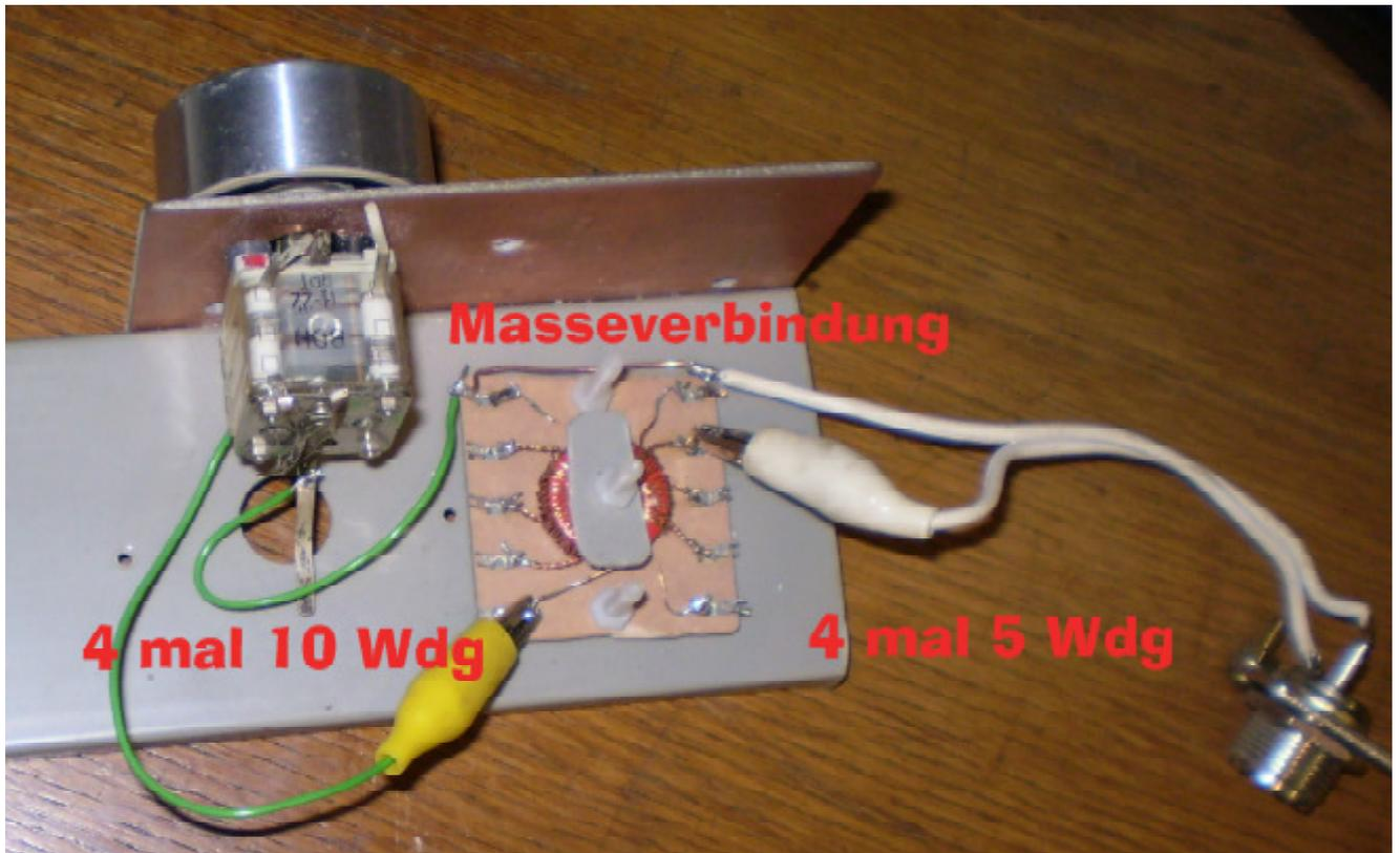
Erfahrungsgemäß haben sehr kurze Strippen eine hohe Impedanz, sehr lange eine niedrige. Entsprechend muß die Antenne angeklemmt werden.
