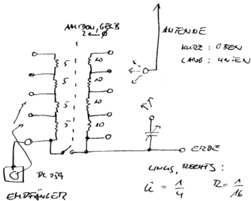
Im praktischen Betrieb kann eine 30 – 50 cm lange Krokoklemme am oberen Kontakt der 10er Reihe einen 50 Ohm-Empfängereingang, der an die unterste Anzapfung der 5er Reihe angeschlossen ist, bedienen. Vielfach werden je nach Antennensituation umfangreiche Antennenverstärker überflüssig.
