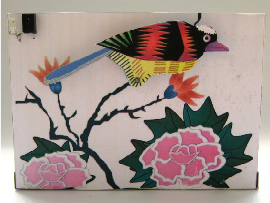
Abb. 2 Vorderansicht des verrückten elektronischen Vogels. Links oben ist die Reflexionslichtschranke befestigt. Der Fototransistor ist in einem Schutzgehäuse untergebracht, um eine Direktbestrahlung durch die IR-LED zu verhindern.
